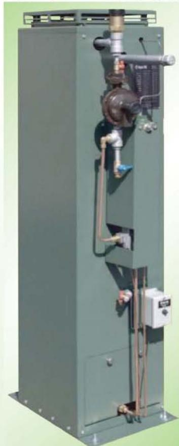
厌烦液化石油气用不完、结冰、结霜由此引起重大损失吗？想寻找一种简单，经济，便于安装的解决办法？在缺乏电力或需要一种便携式液化石油气气化器的选择吗？不要再观望，不要再犹豫，美国 Algas - SDI 直燃型气化器给您一个安全及简单的解决办法，满足您的汽化需要。此款直燃式气化器把液态 LPG 转成气态，输送到管网或混合器。这种中小型能力的气化设备具有广泛用途，比如公路加热、粮食烘干、采暖、焚烧、商业烘烤和烹调等，在不可中断燃气供应的场合，气化器（与混合器配套）可作为备用系统提供不间断燃气，并保持峰值气量。
